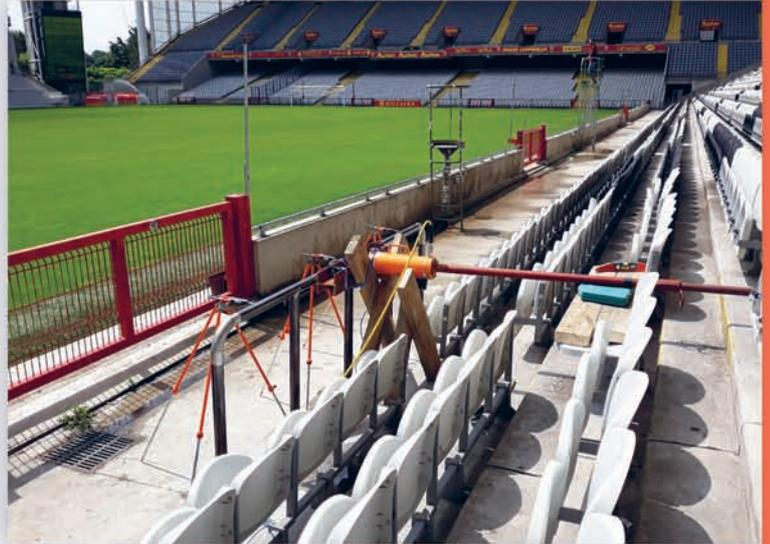
Les marches et contre marches de l'escalier des gradins ont été utilisées pour mobiliser la réaction à l'effort mesuré par une cellule de charge étalonnée et vérifiée.
