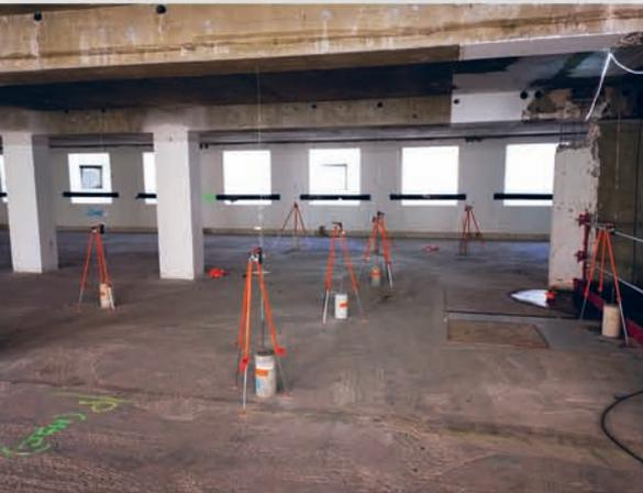
> Dans le cadre de la rénovation d'un immeuble situé à Courbevoie, Rincenc Ile de France Sud a réalisé un essai de chargement de plancher pour mesurer les déflexions de la structure sous les nouvelles charges d'exploitation.
